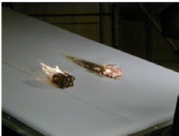
試験状況(火種設置)
