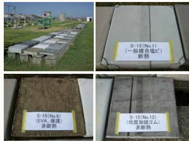
図1 暴露状況 (暴露地: 宮古島)
