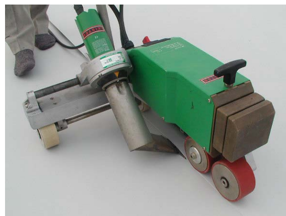
自動溶接機による熱融着
