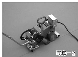
写真-2 自走式熱風融着機によるシート接合
