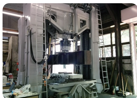
写真 - 1 載荷試験機下地鉄板取付け
